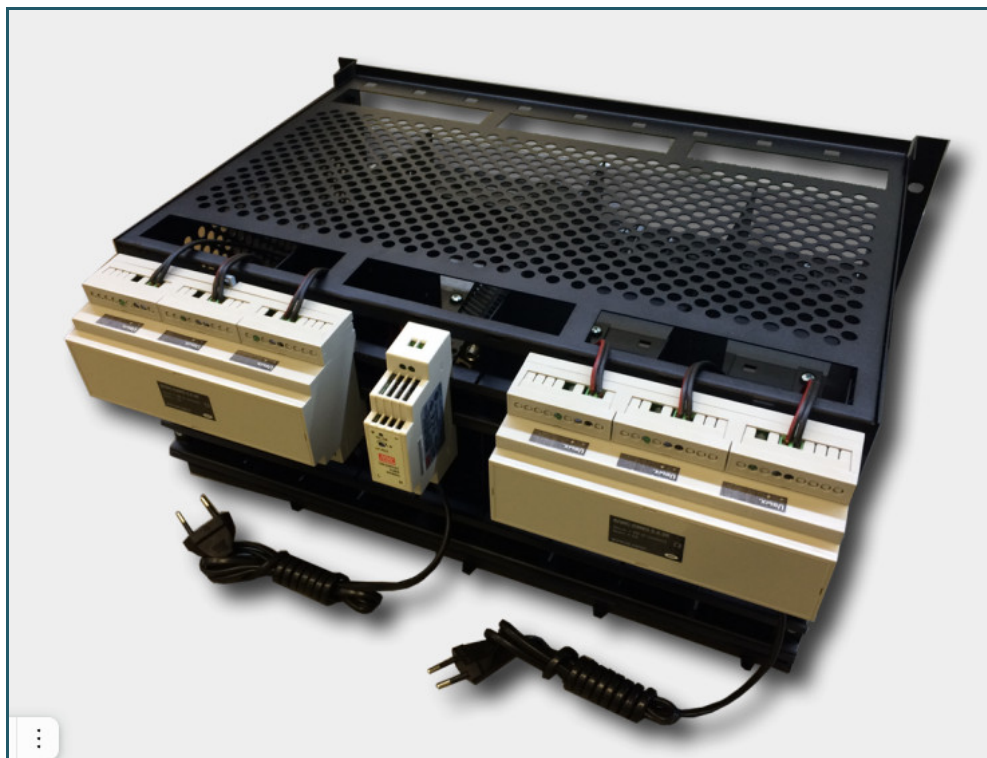
Пример размещения блоков питания на задней стороне шасси
